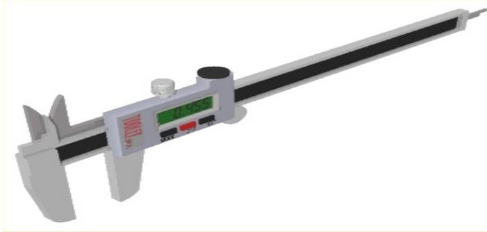
Une mesure de distance s'appelle aussi **une côte**, d'où le nom de **cotation** sur les dessins.
