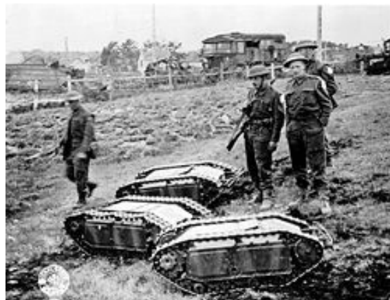
Le Goliath est un petit engin chenillé téléguidé utilisé par la Wehrmacht lors de la Seconde Guerre mondiale. Il disposait d'une charge d'explosifs pouvant être actionnée à distance, afin de détruire un char ou une place fortifiée. http://fr.wikipedia.org/wiki/Goliath_(chenill%C3%A9)
