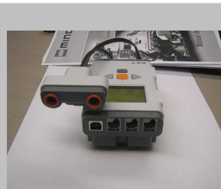
Brancher le fil de connexion au port d'entrée 1 et dans le capteur d'ultrasons. Fixer le capteur ultrasons sur le côté avant de la brique NXT.
