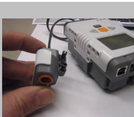
Assembler les fiches de connexions au capteur d'ultrasons.
