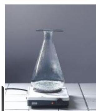
A On fait bouillir un peu d'eau dans un erlenmeyer puis on le ferme par une plaque de verre.
