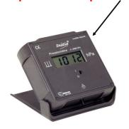
Un manomètre indique la différence entre la pression du gaz à l'intérieur de la seringue et la pression atmosphérique
