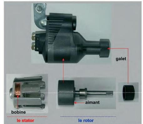
Démontage d'un alternateur (ou génératrice) de vélo présentant les deux parties principales: l'aimant cylindrique et la bobine
