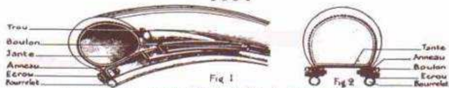
Le premier pneu démontable à anneaux fermés C'est sur ce pneu que Ch. TERRONT gagne la course Paris-Brest
