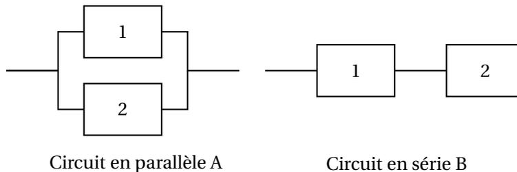
1. Lorsque les deux composants sont montés « en parallèle », le circuit A est défaillant uniquement si les deux composants sont défaillants en même temps. Calculer la probabilité que le circuit A soit défaillant avant un an.
