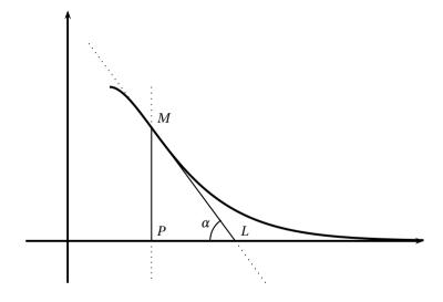
Les contraintes imposent que l'angle  $\alpha$  soit inférieur à 55 degrés.
