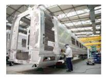
Heute Züge in Siemens wurden am meistens mit Aluminium gebaut. Die Aluminium Blätter werden danach in eine Besetzung geschmolzen, um die Forme des Zuges zu nehmen. Dann Fraisen polieren die Enden und schneiden die Löcher für die Türe und Fenster.
