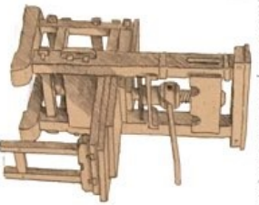
Presses à imprimer de Gutenberg, sans doute inspirées par les presses à vis des imprimeries de la vallée du Rhin.
