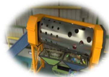
Séparation des déchets dans un tromel
