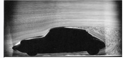
Écoulement d'air sur une voiture provoquant des frottements.
