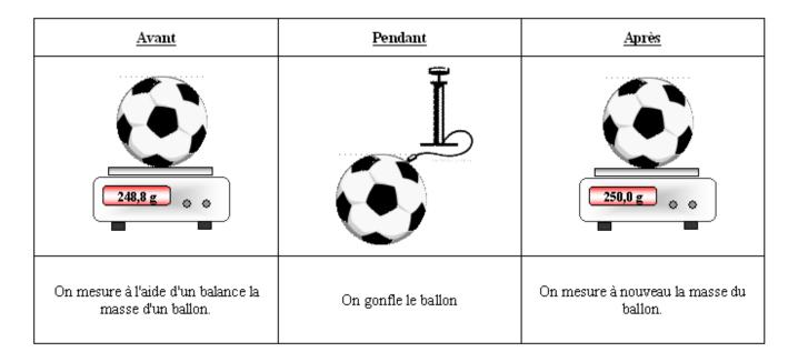
Deuxième étape : comment mesurer à l'aide d'un ballon la masse d'un litre d'air ?
