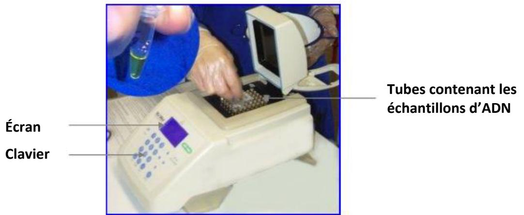
Un thermocycleur est un appareil qui permet de copier un morceau précis d'ADN en utilisant la méthode PCR.
