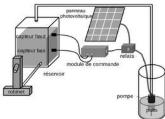
Lorsque le niveau de l'eau dans le réservoir atteint le capteur haut, l'ordre est donné d'arrêter la pompe.
