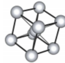
Exemple d'une maille de fer alpha : structure cubique centrée.
