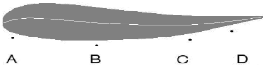
Figure 1.9 - Distribution des points d'attache du faisceau de suspentes sur l'aile.
