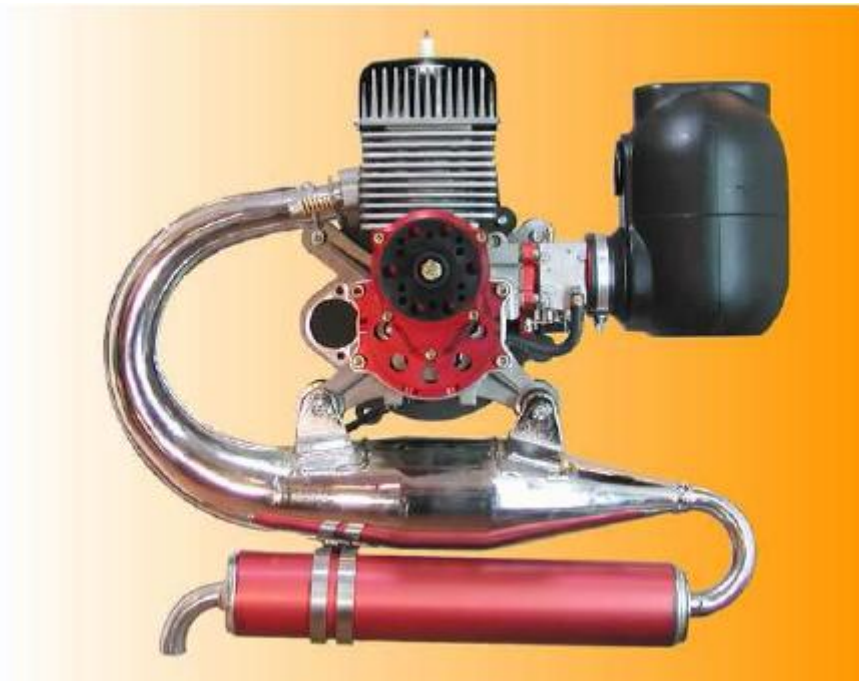
Figure 1.11 - Moteur de cylindrée 100 cm 3 avec transmission à engrenages.
