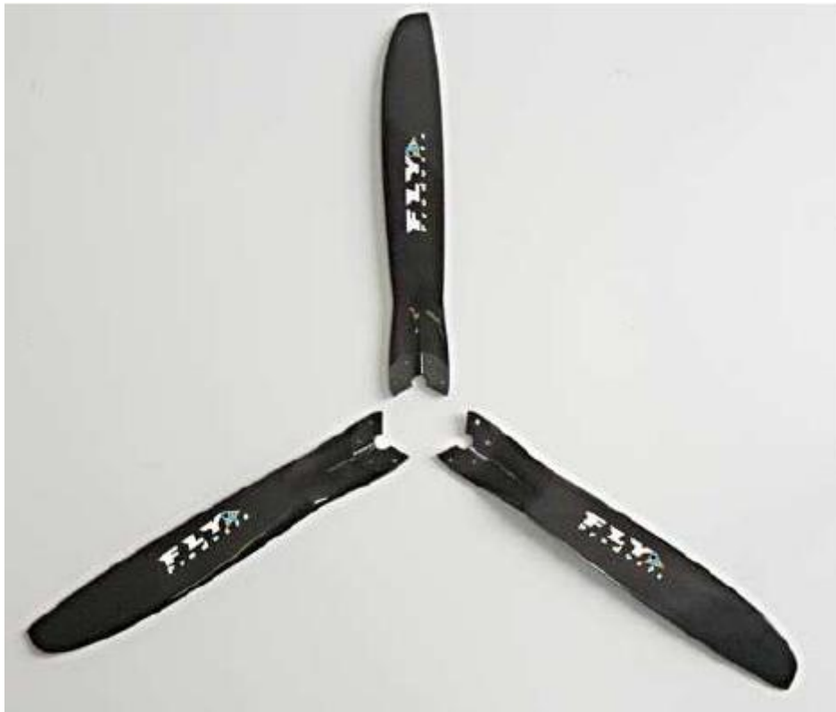
Figure 1.12 - Hélice tripale en composite
