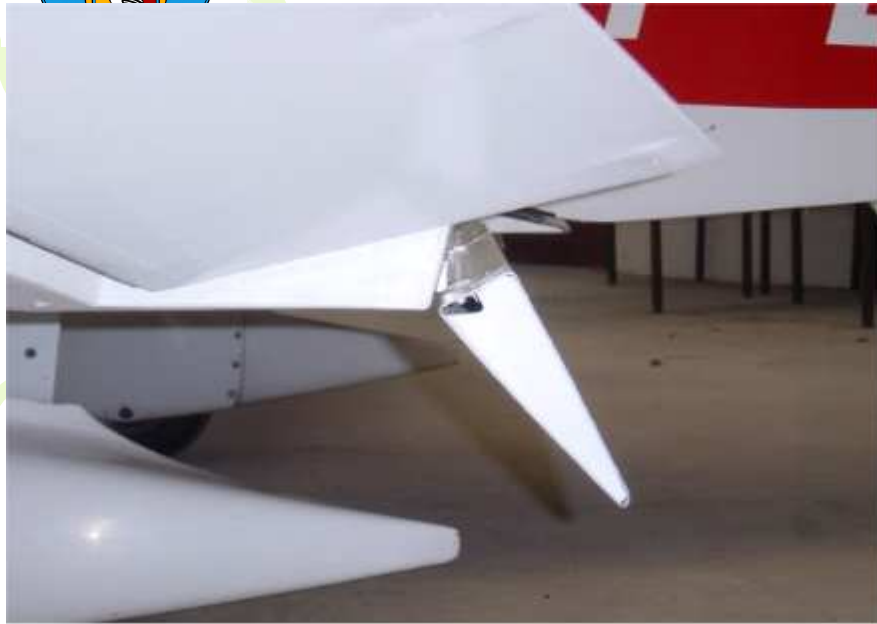
Autre type de volets : Volet simple BF (bord de fuite)
